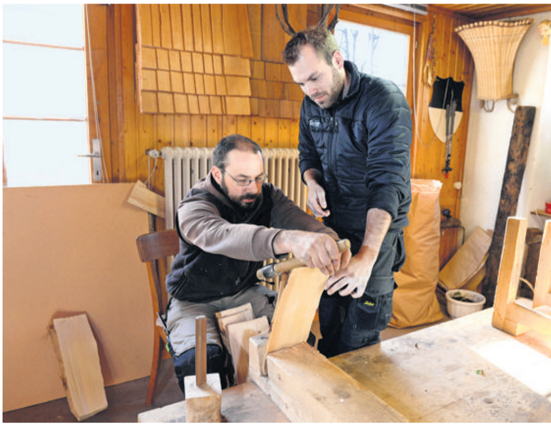
Les tavillons se fabriquent l'un après l'autre. Hubert Chenevey apprend les gestes justes sous l'œil de Florian Despond, de 10 ans son cadet. CHANTAL DERVEY
